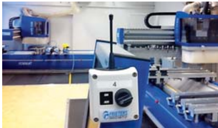
/ HM-Spoerri: Hier kommunizieren Felder-Maschinen per Funk mit der Absaugung.
